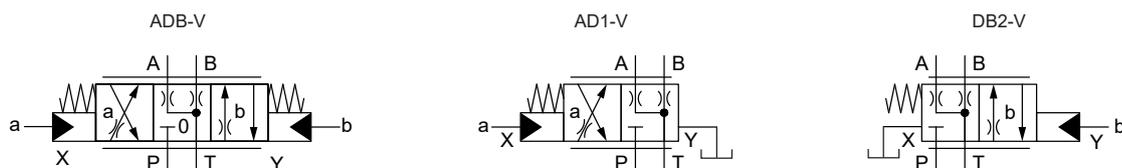
\* Diese 4/2-Wege-Ventile mit Federrückstellung werden als 4/3-Wege-Ventile ausgeliefert.
