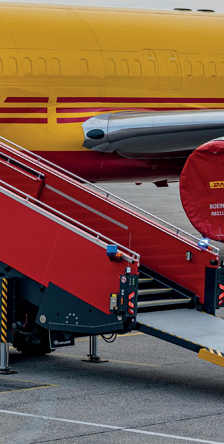
Ein medizinischer Notfall, Rauch in der Kabine oder eine Evakuierung – bei einem Zwischenfall an Bord eines Flugzeugs müssen schnell und effizient Maßnahmen ergriffen werden. Das Aircraft Interior Access Vehicle von Rosenbauer, besser bekannt als Rettungstreppe für Flugzeuge, soll Passagiere und Besatzung im Notfall so schnell wie möglich helfen. Um das Fahrzeug weiter zu verbessern, hat Rosenbauer in Zusammenarbeit mit TTControl die elektronische Architektur von Grund auf neu gedacht.
