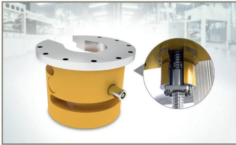
Bei dem patentierten neuen Kraftaufnehmerkonzept von GTM handelt es sich um einen einseitig geschlitzten Zylinder, der Kräfte über das Schubspannungs-Prinzip erfasst. Dies ermöglicht die Messung der entstehenden Kräfte für einen Nennkraftbereich von 20 bis 200 kN sowohl in Zug- als auch in Druckrichtung. Der Kraftaufnehmer besitzt eine großzügige Durchführung in seiner Längsachse, um ihn beispielsweise über einer (Gewinde-)Stange oder einem Profil zu montieren. Lochkreise im Kraftsensor erlauben
