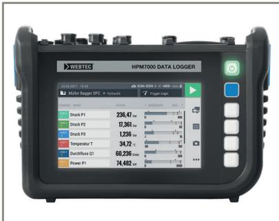
Der tragbare Hydraulik-Datenlogger HPM7000 von Webtec erfüllt die Anforderungen eines breiten Anwenderprofils, u.a. in den Bereichen hydraulische Systemdiagnose, Prüfstände, Vorversandkontrolle oder F&E. Das Basismodell HPM7000 bietet
