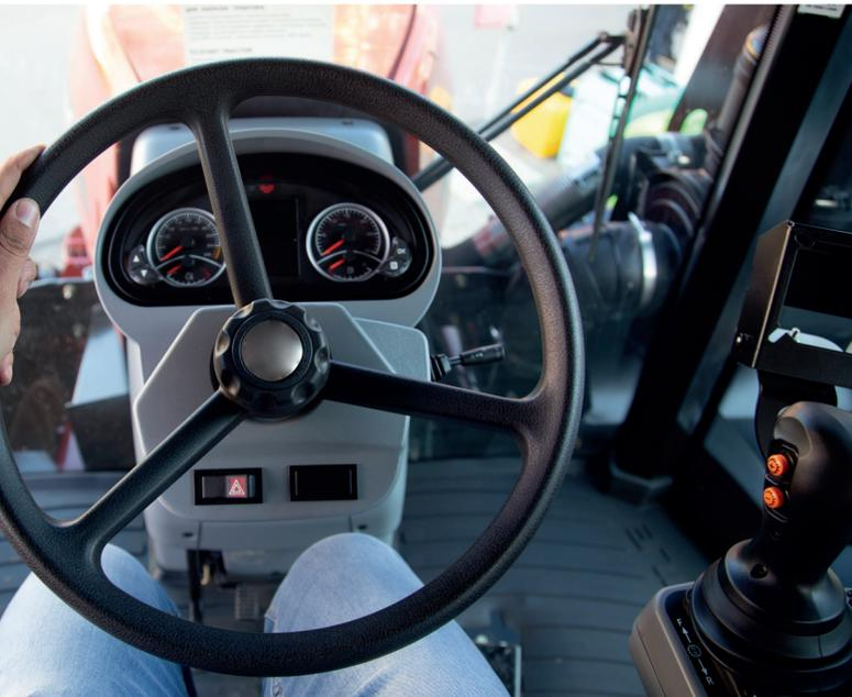
**Force Feedback-Bedienelemente ermöglichen als Mensch-Maschine-Schnittstelle eine feinfühligere Krafterückkopplung an den Maschinenführer**
