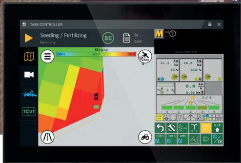
Parker Hannifin erweitert seine ISOBUS Suite-Software um eine Vollversion des ISOBUS Task Controller (TC) für das standardisierte Arbeitsmanagement landwirtschaftlicher Fahrzeuge wie Traktoren, Erntemaschinen und andere selbstfahrende Maschinen.
